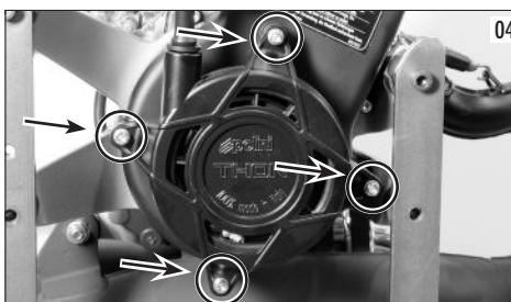
Rimuovere il nodo della maniglia. Fare attenzione perché la ruota centrale ruoterà fino a completo scaricamento della molla; trattenerla e farla scaricare lentamente in modo da evitare danni e pericolo di farsi male. Rimuovere la vite centrale ed il relativo coperchio (foto 5).
