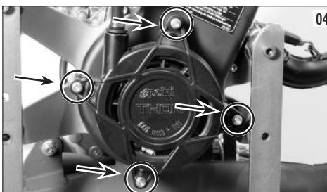
Enlever le nœud de la poignée. Faire attention puisque la poulie centrale tournera jusqu'à la complète décharge du ressort; la tenir et la faire tourner lentement, de façon à éviter quelconque dommage et blessures. Enlever la vis centrale et le couvercle (photo 5).
